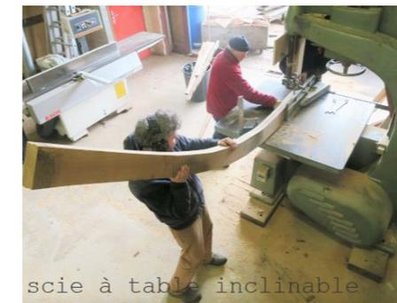
Nous sommes équipés comme un atelier de menuiserie classique avec une dégauchisseuse, une raboteuse, une fraiseuse et des scies à ruban. La scie à ruban est très importante car, une fois que les membrures sont tracées à partir des gabarits, il faut les retailler. Vous voyez, tout est dans la courbe, le bord de
