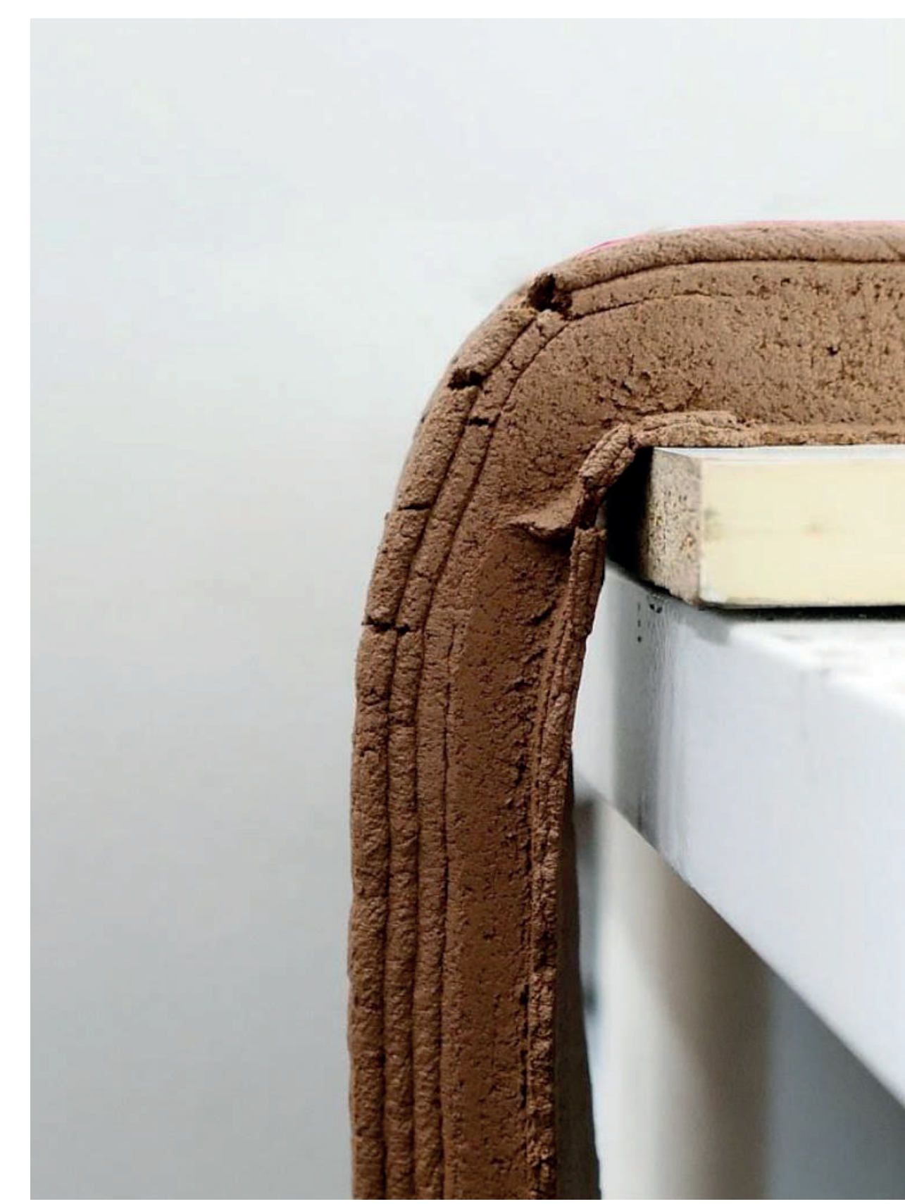
Échantillon 2 : corde lâche Longueur en suspension : 27 cm Source : IAAC
