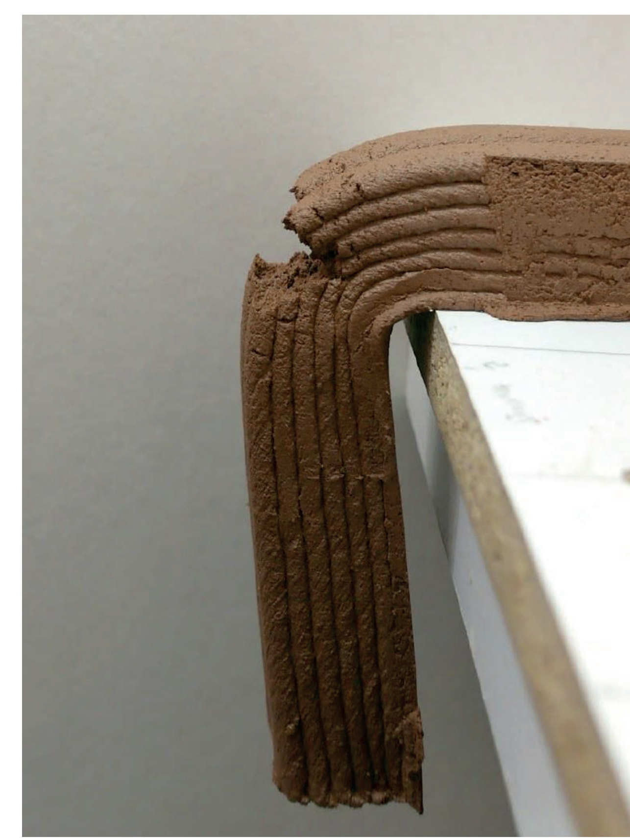
Échantillon 1 : sans corde Longueur en suspension : 11,5 cm Source : IAAC
