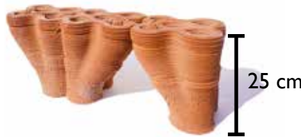
Ci-dessus : Essai à échelle 1 du porte-à-faux nécessaire à la création d'ouvertures dans le mur.
