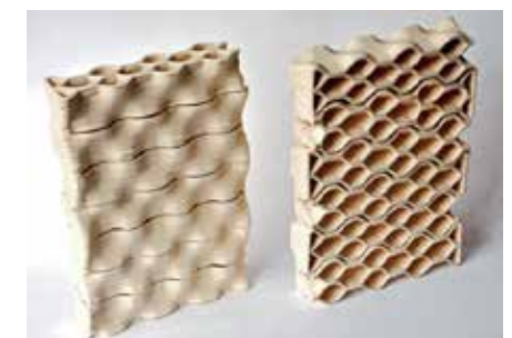
Ci-dessus : impression d'une brique alvéolée et assemblage selon différentes directions.
