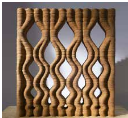
Ci-dessus : Prototype final du projet Porous Wall. (1m x 1m x 20 cm ; 115 kg de matière ; 18h d'impression).
